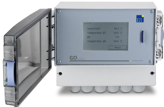
Der **BlueSense** Messumformer kann durch Speicherung der Messdaten auf einer SD-Card auch als Daten-Logger genutzt werden. Die Bedienung erfolgt über das Touch-Display. Weitere Funktionen beinhalten die Schaltung von Relais bei Über- und Unterschreiten einstellbarer Alarmwerte und kann kundenspezifische Programme ausführen. Ein PID Regler steht ebenso zur Verfügung. Auch das Vernetzen mehrerer Messstellen über einen Feldbus ist möglich.
