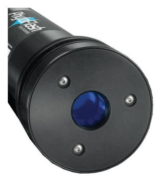
Fluorometer zur in-situ-Bestimmung direkt an einen PC angeschlossen, um so die Messdaten online aufzunehmen. Das **PhytoFlash** kann in diesem Modus bis zu einer von der Länge des Datenkabels abhängigen Tiefe direkt unter Wasser, oder aber außerhalb eines Gewässers unter Verwendung einer Durchflusszelle eingesetzt werden. Im "Online/Labor-Modus" ist neben den oben genanntem Photosynthese-Parametern auch die Response-Curve für den Anwender zugänglich.
