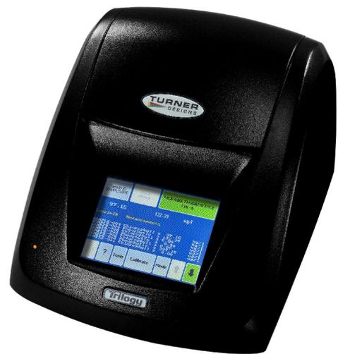
Das System ermöglicht das Speichern von bis zu 18 Kalibrierungen. Zur Überprüfung von Kalibrierdaten kann ein Festkörper-Sekundärstandard eingesetzt werden, der auch zur eventuellen Nachkalibrierung dient. Dadurch wird dem Anwender das sonst immer wiederkehrende Ansätzen von flüssigen Standards erspart, wodurch schließlich auch die betriebsbedingten Kosten bei der Nutzung eines Fluorometers deutlich reduziert werden.
