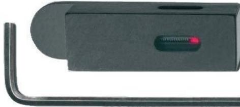
Zur Einstellung der gewünschten Fluoreszenzintensität lockern Sie zunächst die kleine Arretierschraube an der Seite. Anschließend können Sie mit der von oben zugänglichen Justierschraube die Fluoreszenzintensität des Festkörper-Sekundärstandards verändern. Wenn der von Ihnen gewünschte Wert angezeigt wird, ziehen Sie die Arretierschraube wieder an, und messen dann nochmal den Wert.
